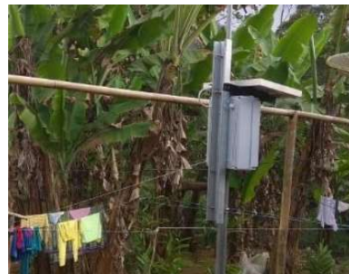
Gambar 13 Pemasangan Alat Sistim Pringatan Dini (EWS) tanah Longsor
